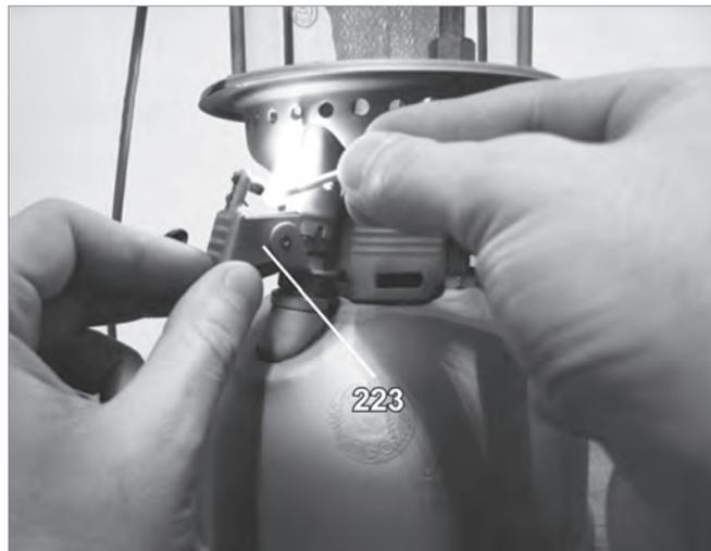
1. 予熱バーナーのレバー(223)を手前に押し下げてマッチで点火してください。予熱バーナーから炎が勢いよく噴射してジェネレーター(152)を熱しはじめます。
