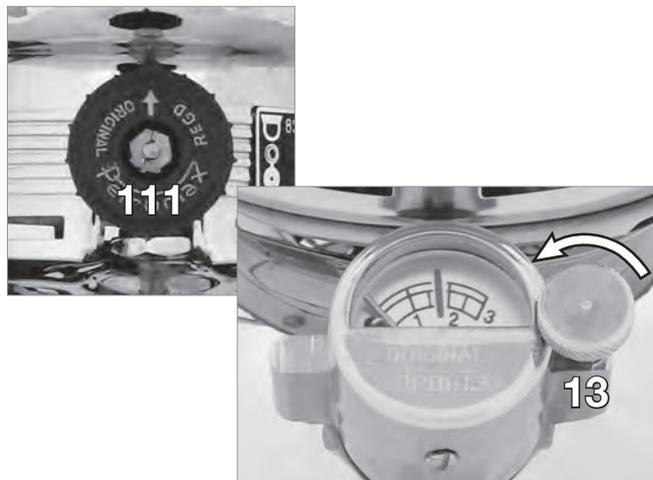
1. 圧力計の横についている圧力調整スクリュー(13)を反時計まわりに回すとタンクの圧力が抜けて自動的に消火します。
